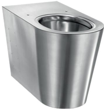
Esta bacia convencional fabricada em aço inox AISI 304 com espessura de 1,5 mm e acabamento escovado, é indicada para locais com alta circulação de pessoas. Com alta durabilidade, possui parafusos antivandalismo. Tem entrada e saída de água horizontal e vertical, além de lavagem perimetral e atende à norma EM 997 para descarga de 6 Lpf.
