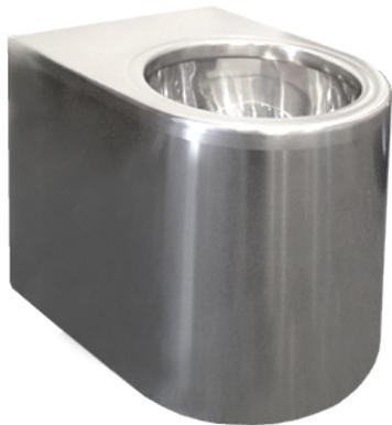
Esta bacia sanitária tem estrutura robusta, fabricada em aço inox AISI 304 com espessura de 1,5 mm. Possui saída de água horizontal para acesso por galeria técnica ou saída de água vertical com acesso lateral.
