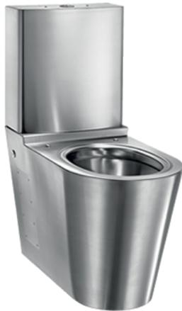
Desenvolvida para atender locais com médio tráfego de pessoas, como bares, restaurantes, instituições de ensino, entre outros, esta bacia com caixa acoplada e dupla descarga é fabricada em aço inox AISI 304 com espessura de 1,5 mm tem acabamento escovado. Possui entrada de água inferior e saída de esgoto horizontal ou vertical, além disso, cumpre a norma EM 997 para descarga 6 Lpf.
