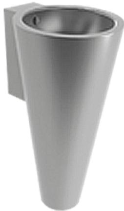
Fabricada em aço inox AISI 304, com acabamento escovado e 1,2 mm, esta peça é indicada para bares, restaurantes, instituições de ensino, órgãos públicos, entre outros. Cuba estampada, com design e formato versáteis, pode ser de piso, fixada à parede ou ao pavimento, além de incluir válvula simples de 1 ¼. Atende à norma EM 14688 (determinação da estabilidade dimensional), possui furo ladrão opcional, furo para torneira ou misturadora (Ø 22 mm/Ø 35 mm), opcional, ao centro.
